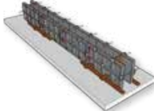
Betonnen balken op betonplaat
