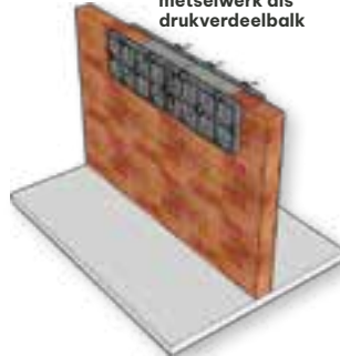
Betonbalk op en tussen metselwerk als drukverdeelbalk
